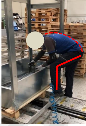
Şekil 20 Operatörün alt taban sacının hücre içerisine montaj alt faaliyeti adımı
