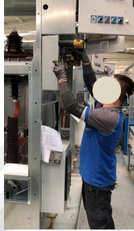
Şekil 67 Operatörün mavi kapak yan sacı montaj işlemi alt faaliyet adımı
