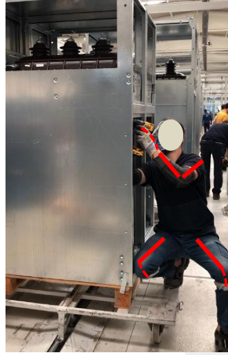
Şekil 54 Motor switchi kabloları montajı alt faaliyet adımı
