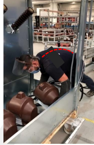
(a) Trafoların taşıma arabasına aktarılması (b) Trafoların hücre içerisine aktarılması
