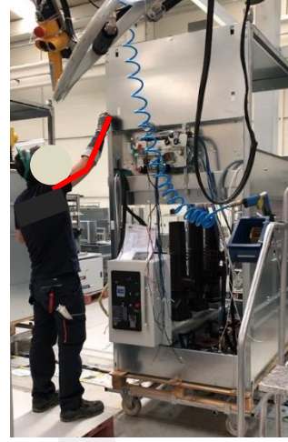
Şekil 52 İstasyon 8’de kablo düzenlemeleri ve montaj alt faaliyet adımları
