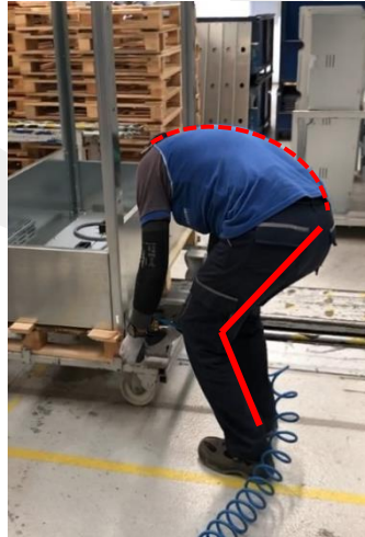
Şekil 22 Operatörün hücreleri paletlere sabitleme işlemi alt faaliyeti adımı
