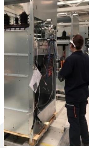
(a) Açma kapama bobini montajı alt faaliyet adımı (b) Kablo uçlarının düzenlenmesi alt faaliyet adımı
