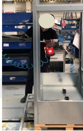
Şekil 26 Destek çitasının havalı perçin sıkıcı ile montaj işlemi alt faaliyet adımı
