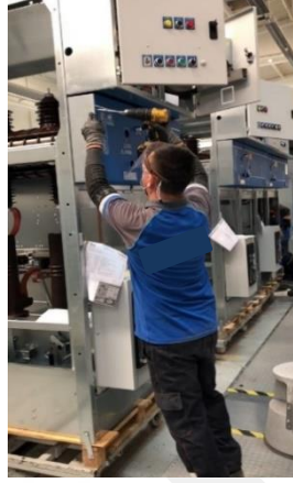
Şekil 69 Mavi kapak kapama şarjlı el matkabı montaj işlemi alt faaliyet adımı
