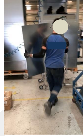
(a) Sol yan duvar sacı montajı alt faaliyet adımı (b) Hücre üst kapama sacı montajı alt faaliyet adımı
