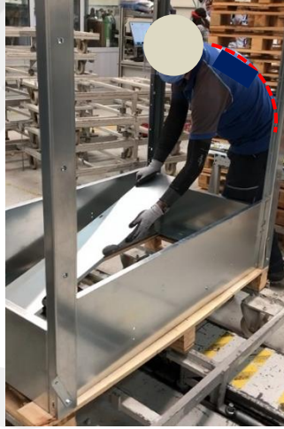
Şekil 19 Hücre içerisine alt taban sacı yerleştirme alt faaliyeti adımı
