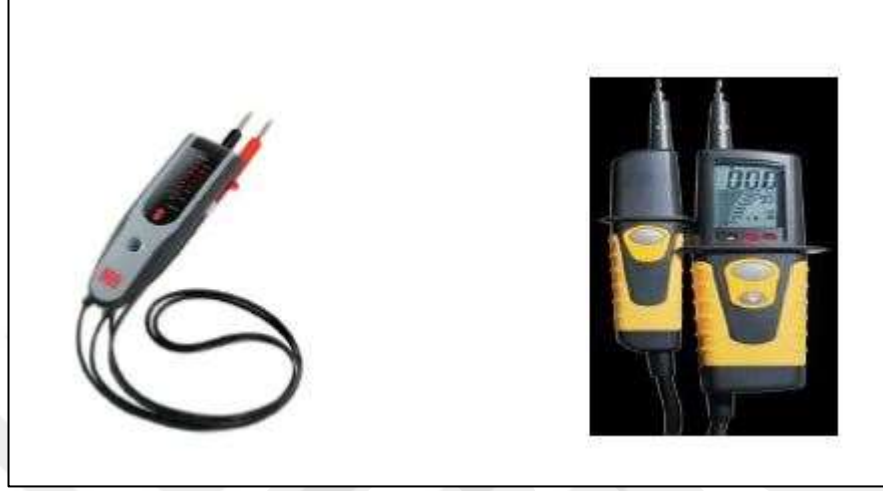
Şekil 10: AG-DC Alçak Gerilim Detektörü (Akın & Ay, 2013)
