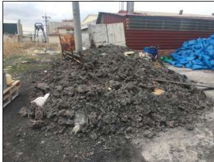
Şekil 11:Gıda Fabrikasında Tespit Edilen Ocak Cürüfları
