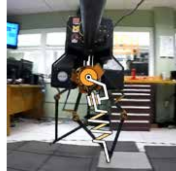
Şekil 1: ATRIAS platformu ve radyal yöndeki sanal SLIP. Bu platformda yaylar mafsal motorlarına eklenmiş fakat doğrusal olmayan bir profil yaratmışlardır.
