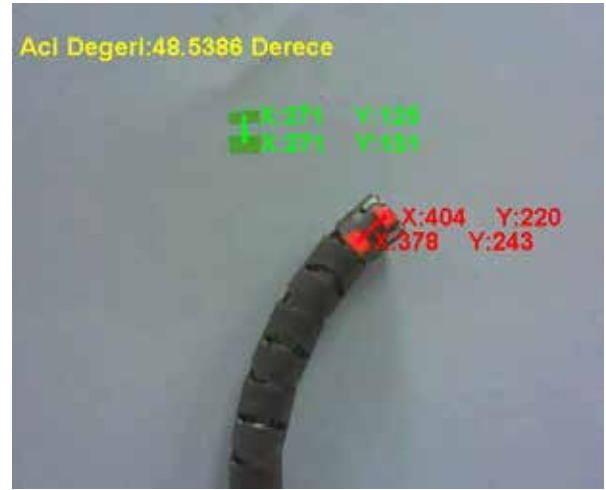
Şekil 6 Uç işlevci pozisyonunun doğrulanması
