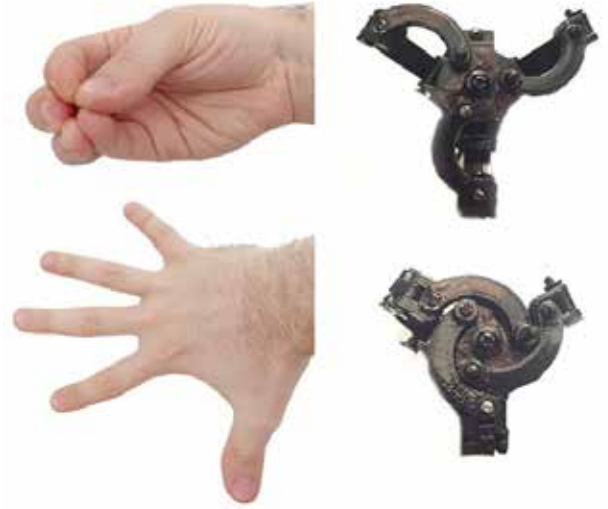
Şekil 8. Operatör el hareketleri ve gripper mekanizmasının çalışması
