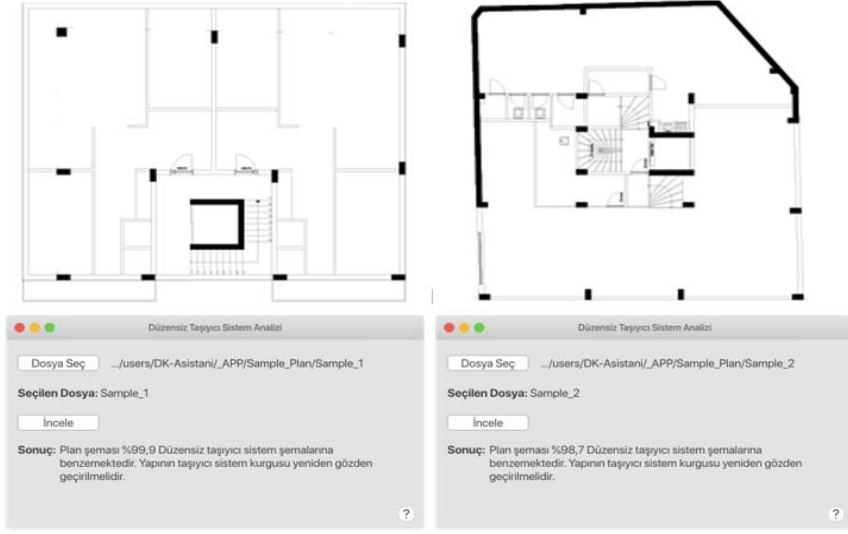
Şekil 10 Düzensiz Taşıyıcı Sistemlere Sahip Planlar için Programın Verdiği Yanıt (Response of the Program for Irregular Structural Systems)
