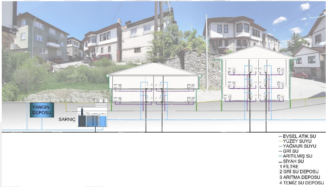
Şekil 49: Gri Su Geri Kazanım Kavramsal Kesit Şeması
