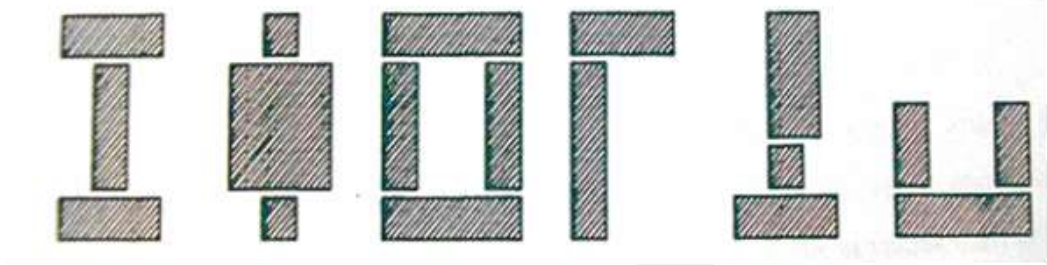
Şekil 5. 9: Dilatasyon İle Yapı Ayırma Örnekleri (Hünük,2006)
